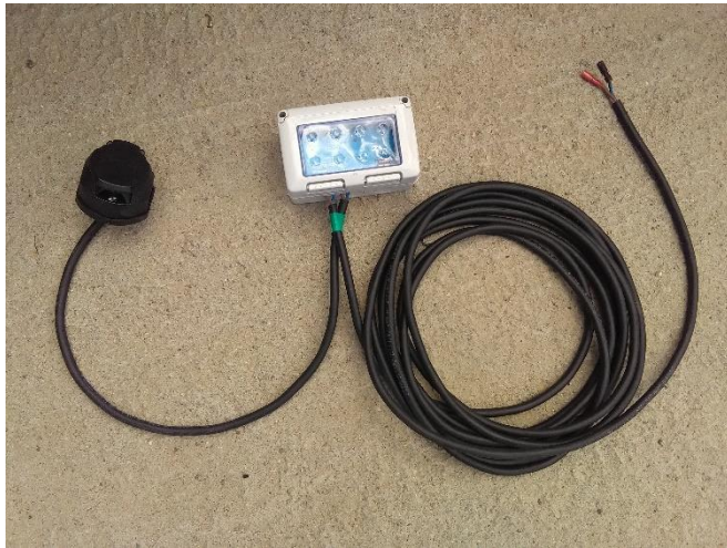
Cumpărat o priză auto pe 13 pini, cablu cu înveliș de cauciuc (e mai rezistent) de 2 x 1,5 mm și două perechi de conectori rapizi (nu am găsit conectori solari), plus o cutie rezistentă la apă (cutie de siguranțe pentru exterior). Total: cam 100 lei
