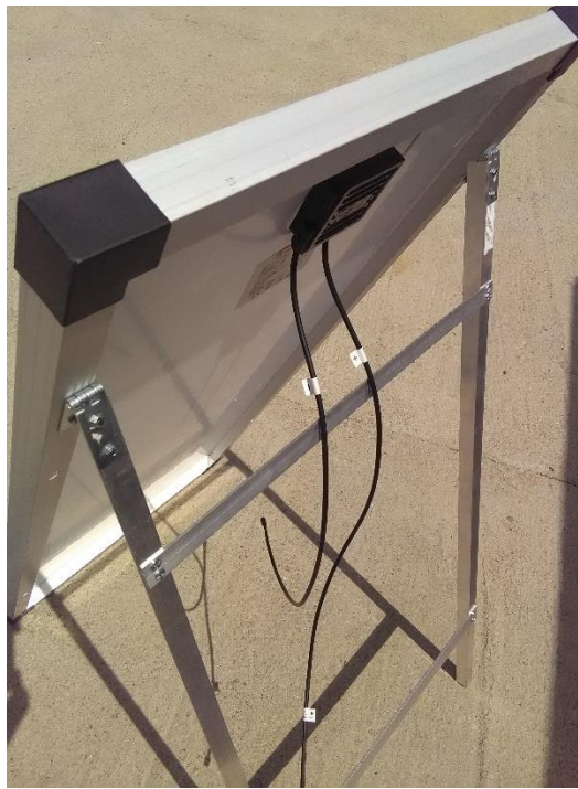
Cumparat de la Leroy Merlin două balamale, 2 corniere si 2 placbade de aluminiu (1,9 lei/balama, 8 lei/cornier, 6 lei/placb.)
